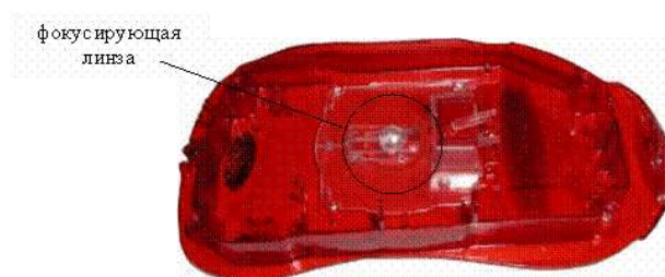
Рисунок 14.5 Устройство оптической мыши
